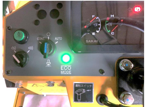
ECOモードのパイロットランプ点灯
