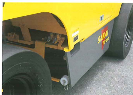
樹脂製散水タンク
