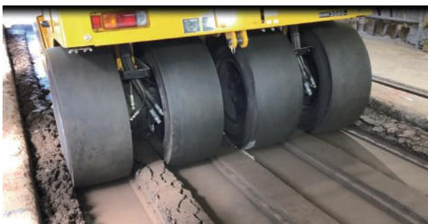
写真-4 TZ-12t (条件:w2) 【走破性判定:△】
