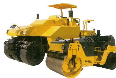
12V: 4t 振動コンパインドローラクラス 24V: タイヤローラ、マカダムローラクラス
