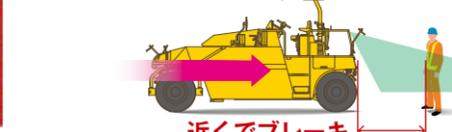
緊急ブレーキが作動しました。前後進レバーをニュートラルに戻して、パーキングボタンを押してください。
