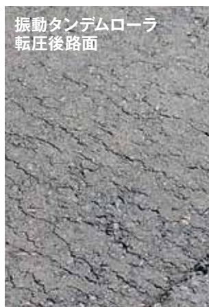
図4 アスファルト舗装におけるヘアークラックの接着効果
