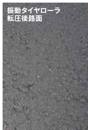
図4 アスファルト舗装におけるヘアークラックの接着効果
