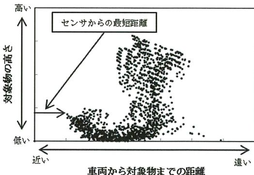
図-2 3Dセンサの検知データの例
