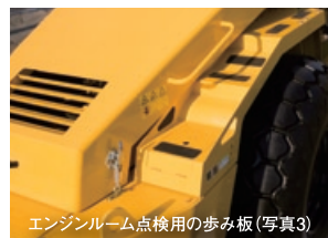
エンジンルーム点検用の歩み板(写真3)
