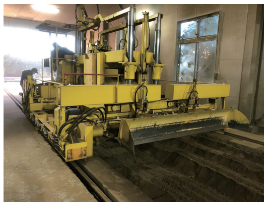
写真-1 敷き均し用ブレード付スタビライザ
