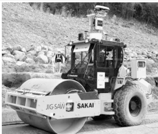
人手不足に悩む建設現場での利用を想定する（酒井重工が開発した自律走行式ローラー）
