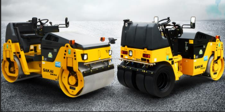
タンDEMローラ(左)・コンバインドローラ(右) 市街地の中小型舗装工事で使用
