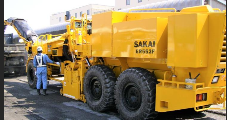
ロードカッタ 道路補修工事に使用 傷んだ既設路面を幅2m/深さ15cmで切削する
