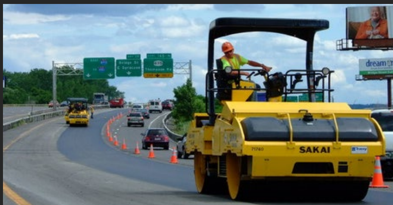
大型舗装用振動ローラ 主に高速道路などのアスファルト舗装工事で使用 アメリカ、中国等の大規模舗装工事にて需要多い
