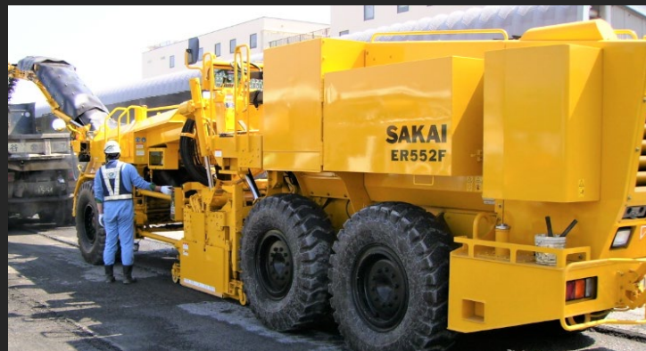
ロードカッター 道路補修工事に使用 傷んだ既設路面を幅2m/深さ15cmで切削する
